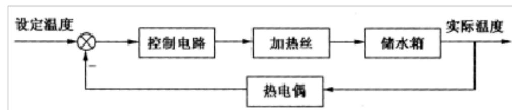
A.被控对象是加热丝 B.被控量是箱内实际水温 C.检测装置是热电偶
