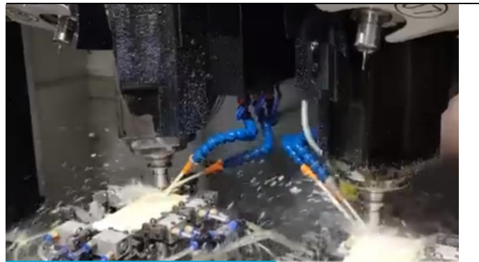
图17: 钻攻中心加工手机外壳
