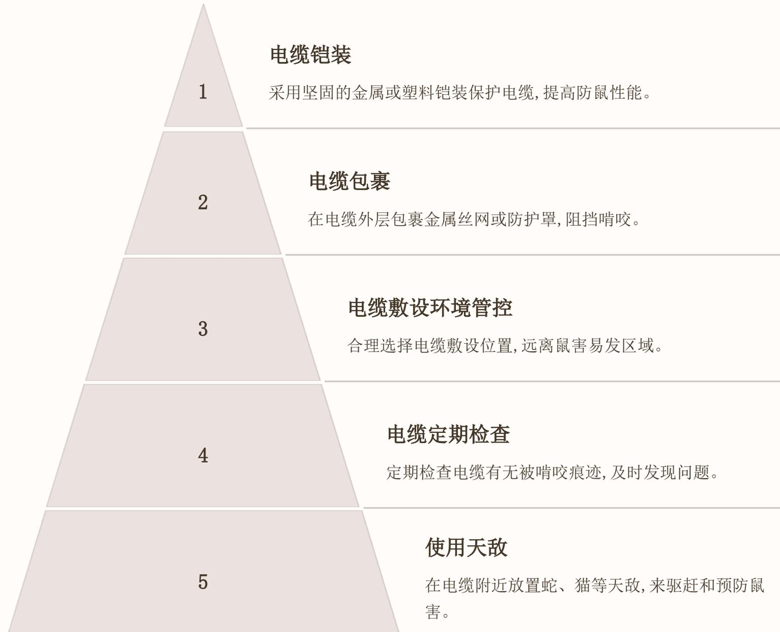
电缆防鼠害措施包括采用坚固的金属或塑料铠装保护电缆、在电缆外层包裹金属丝网等防护罩、合理选择电缆敷设环境、定期检查电缆有无被啃咬痕迹, 以及使用猫、蛇等天敌等方法。通过综合采取这些措施, 可有效预防和控制鼠害对电缆的破坏。
