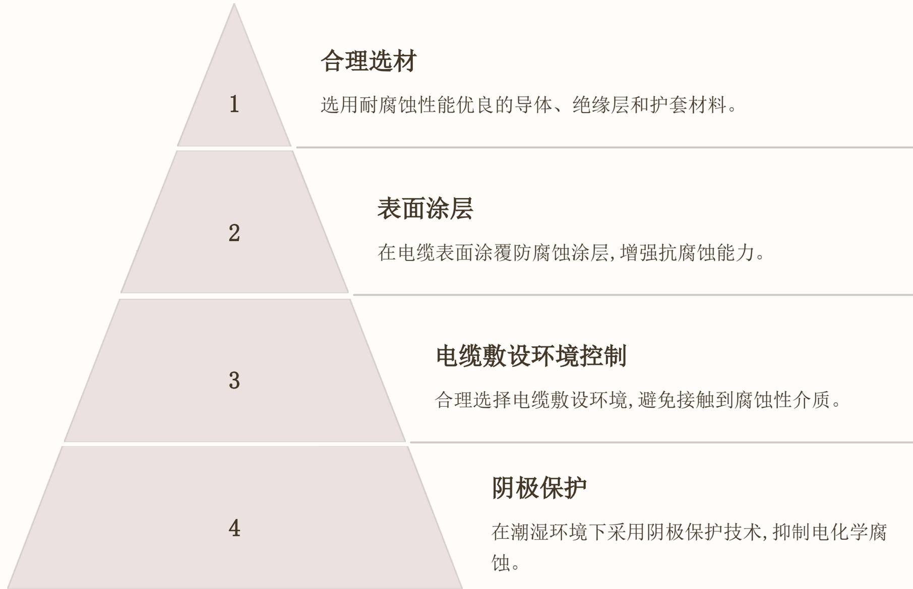
电缆防腐蚀措施包括合理选用耐腐蚀材料、在电缆表面涂覆防腐涂层、控制电缆敷设环境、采取阴极保护等手段。通过综合措施有效防止电缆遭受化学腐蚀, 延长电缆使用寿命。
