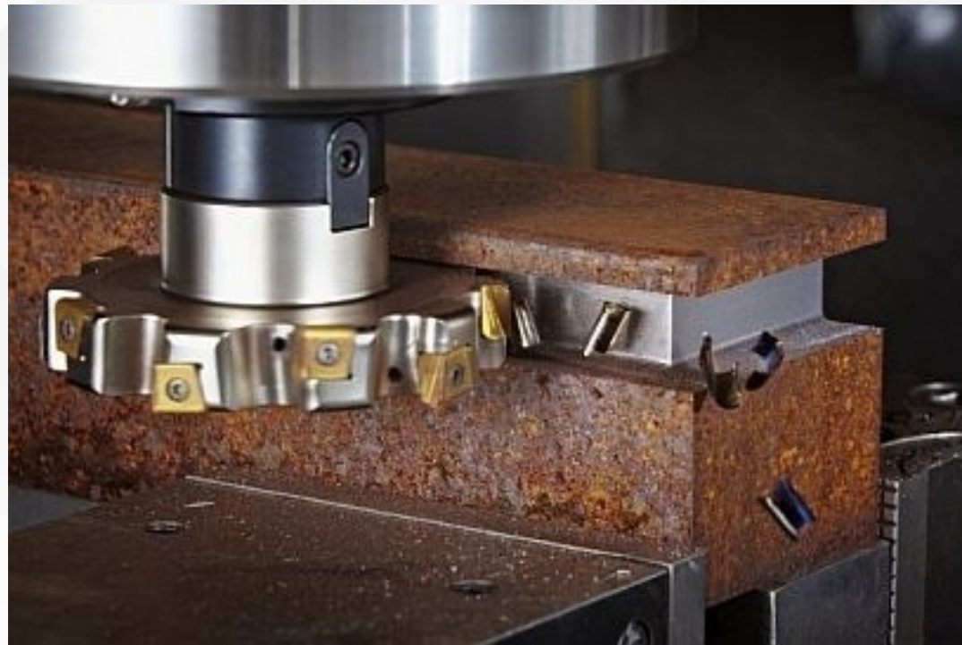
用三面刃铣刀铣通槽 三面刃铣刀，简称三面刃。三个刃口均有后角，刃口锋利，切削轻快
