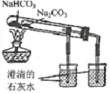
比较  $\text{NaHCO}_3$  和  $\text{Na}_2\text{CO}_3$  的热稳定性
