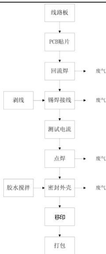
图 2-4 风扇控制器、继电器生产工艺流程图
