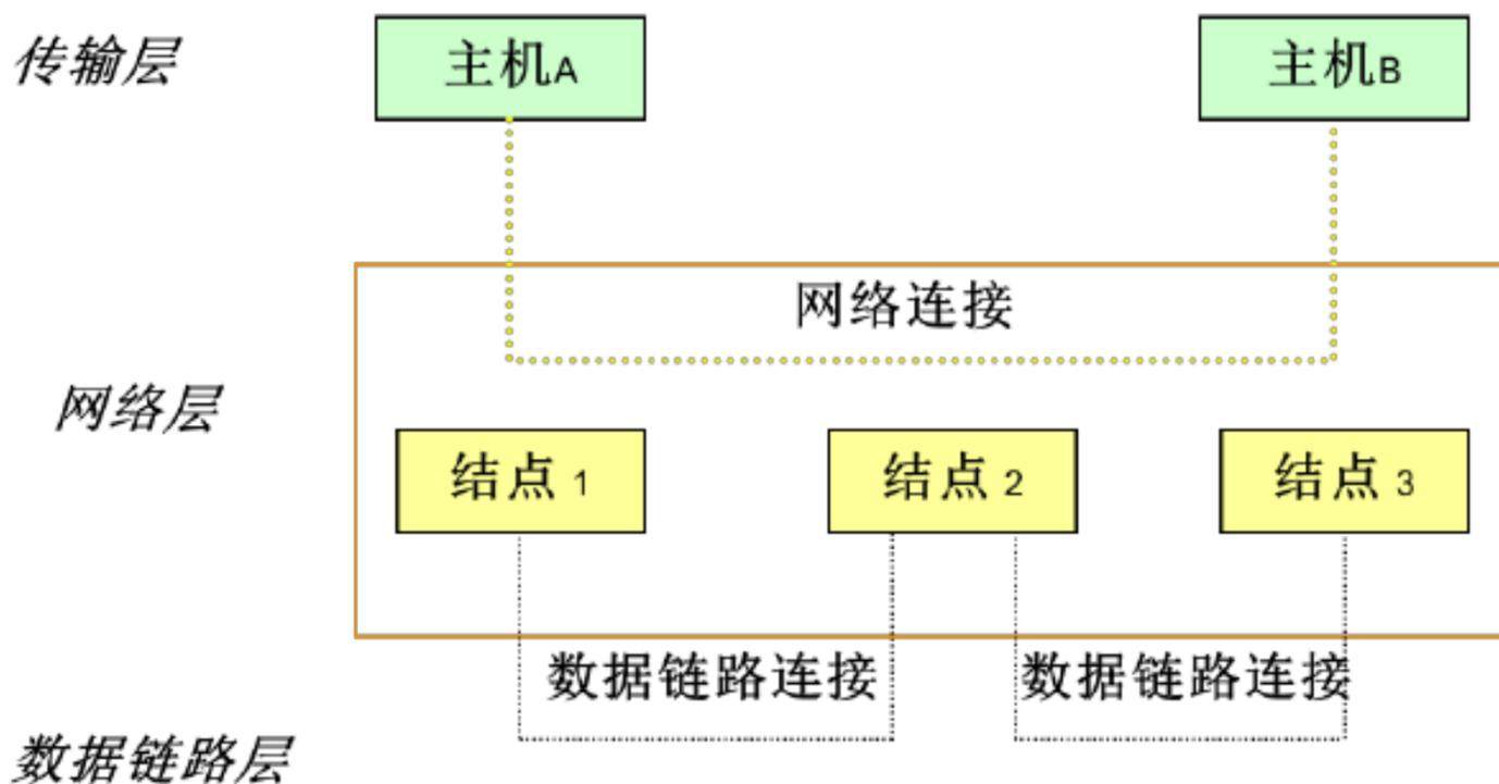
网络层是通信子网的最高层，对上层用户屏蔽了子网通信的细节，如子网类型、拓扑结构、子网数目，向上层提供一致的服务、统一的地址。
