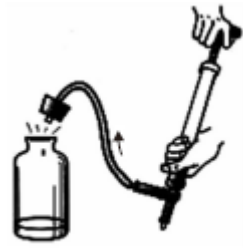
空气被压缩时内能增大 空气推动瓶塞时内能减少
