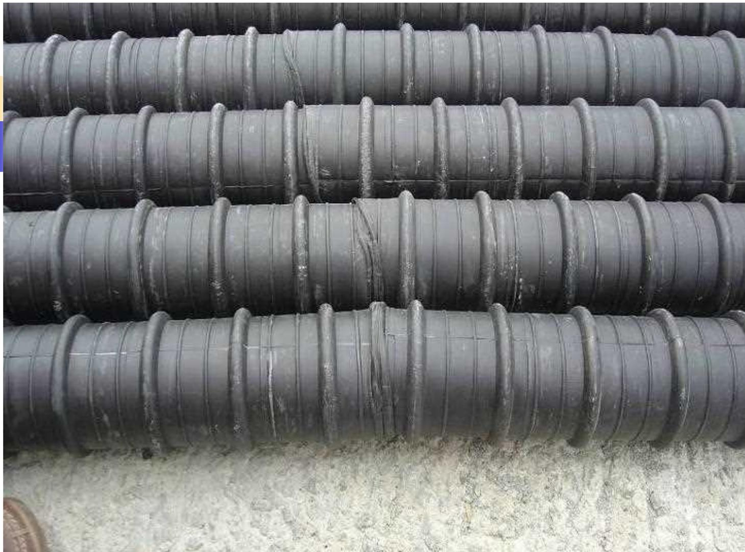
塑料波纹管其刚度比金属波纹管大，孔壁摩擦系数小，不易被混凝土振捣棒振瘪，价格比金属波纹管高。在桥梁的长孔道中应用的比例在增加。
