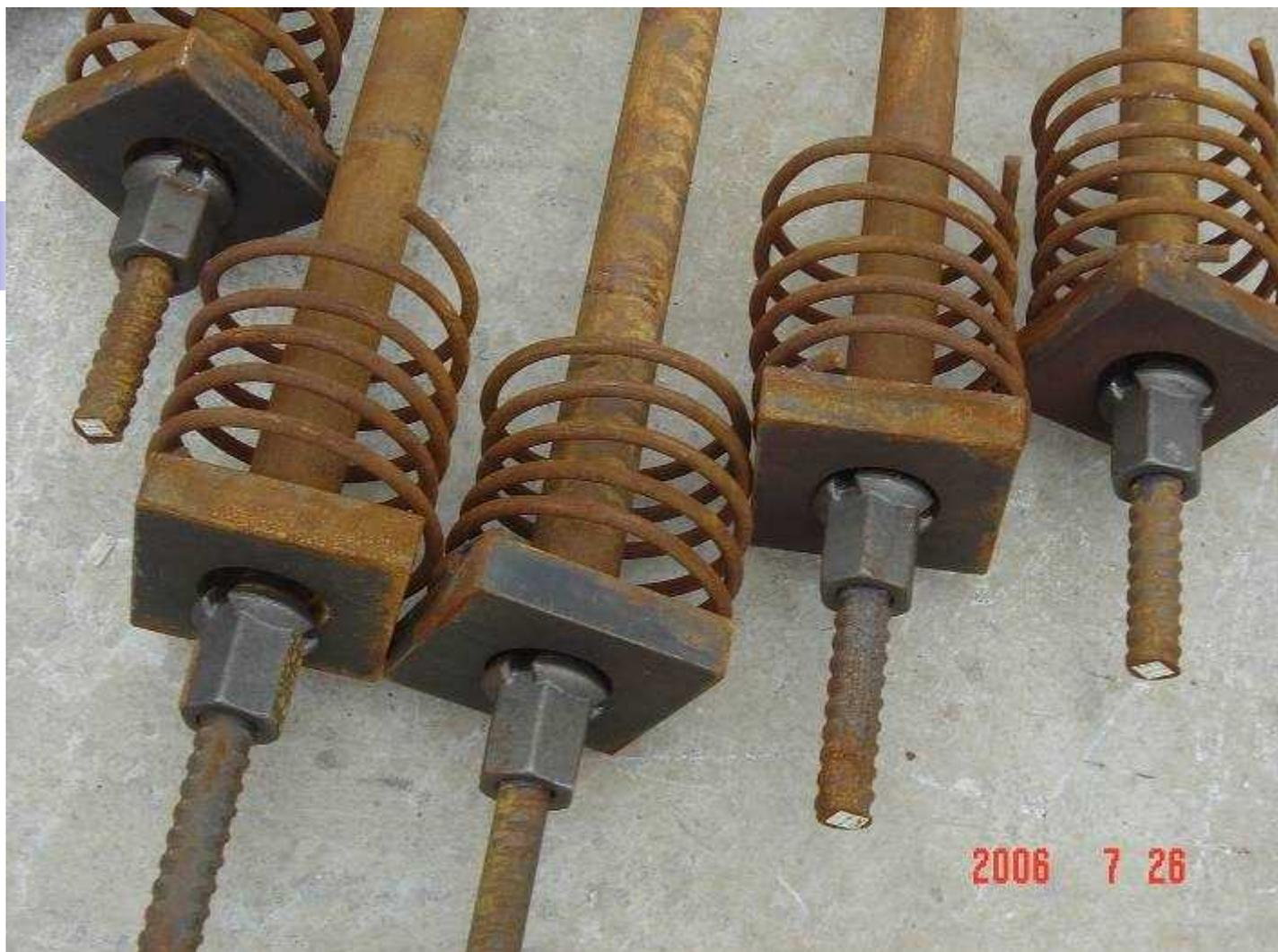
精轧螺纹钢筋的预应力筋主要用于连续梁桥和连续刚构桥的腹板内竖向预应力筋，提高截面的抗剪能力。
