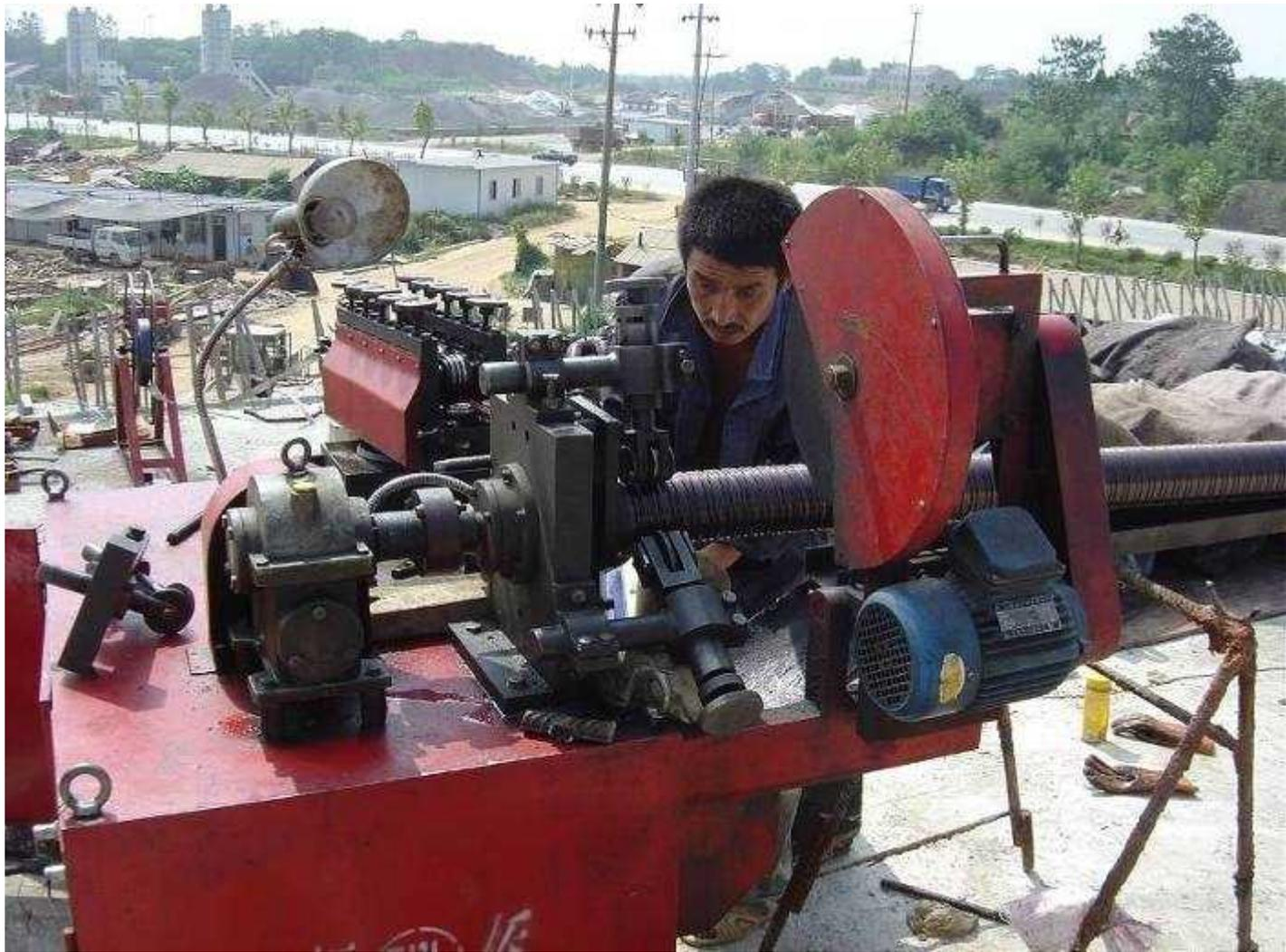
金属波纹管要求咬口牢固，波纹高度符合要求，弯曲的波纹管不渗水，环向刚度足够。
