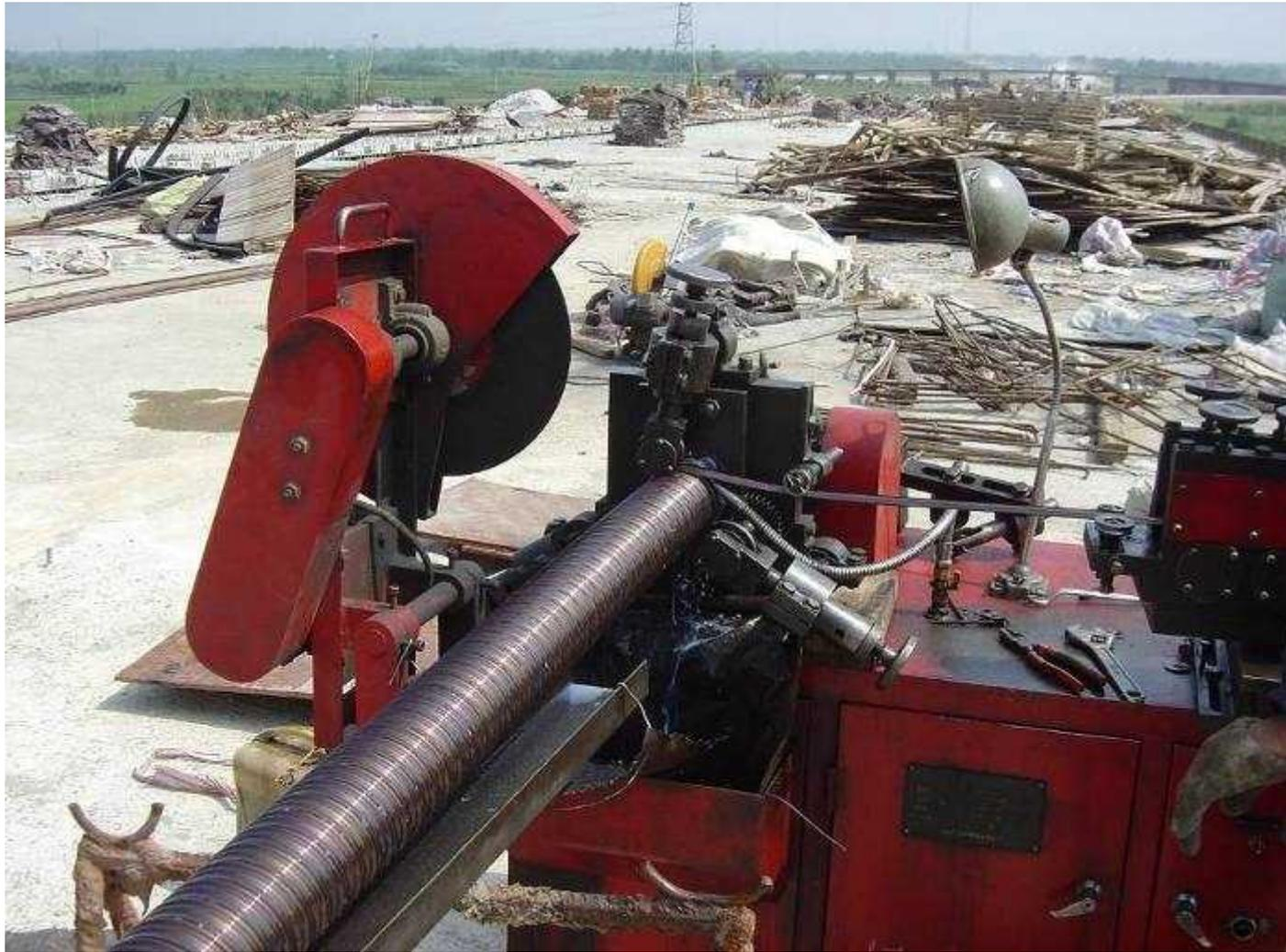
后张有粘结预应力需要留孔，留孔材料通常用金属波纹管。金属波纹管用厚度为**0.3 ~ 0.35mm**的钢带卷制而成。金属波纹管有镀锌和非镀锌之分，波纹有单波和双波之分。
