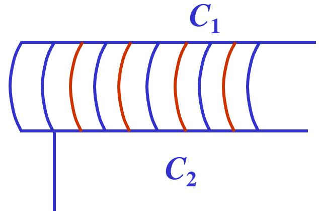
$K$ : 耦合系数，与两回路的相对位置有关，反映两线圈耦合的紧密程度。
